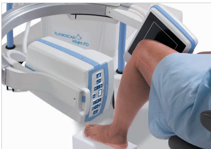
Flachdetektor-Markierung stellt sicher, dass sich ROI stets im Sichtfeld befindet.
